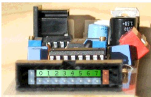
Le connecteur pour câble en nappe 20 fils permet de brancher 8 actionneurs différents, pilotables par des variations de tension entre 0 et 10 V.
