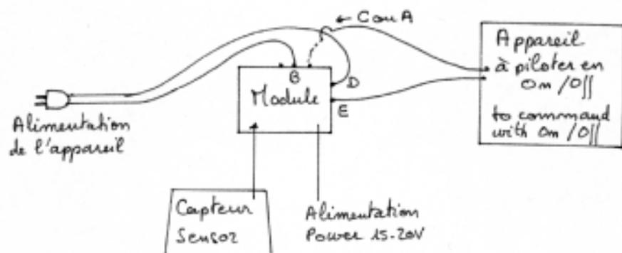
L'un des fils est connecté en position A lorsque l'on veut que l'appareil s'allume quand le capteur est actionné (On).
