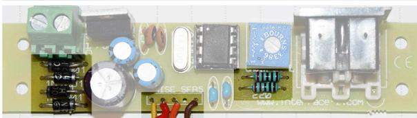
**Diodes** : elles peuvent être indifféremment des 1N4001 à 1N4007. La seule chose importante est leur orientation sur le circuit : l'anneau blanc sur la diode doit être du même côté que la petite barre transversale dans le rectangle sur la sérigraphie. Le non respect de ces orientations peut être destructif.
