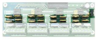
Composants format TO220: Transistors, diodes, 7809. Le rectangle hachuré sur la sérigraphie correspond à la plaque métallique du composant, qui dépasse en hauteur. Il ne faut pas les monter à l'envers, leur sens est crucial : le non respect de ces orientations est destructif.
