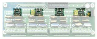
4 Supports DIL8 : Les encoches des supports sont orientées conformément à la sérigraphie : elles permettent de placer les composants enfichables dans le bon sens. Sur la photo les encoches sont toutes vers la droite, vers le 7809.
