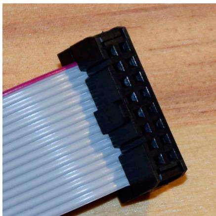
Les dents métalliques ne doivent plus être visibles, le connecteur ne doit pas bailler au milieu ou moins enfoncé d'un côté, les fils doivent être uniformément répartis sur la largeur, le connecteur doit être perpendiculaire aux fils.
