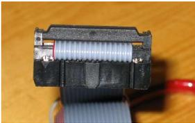
Enclipser éventuellement l'élément anti-arrachage en repliant la nappe sur le connecteur.
